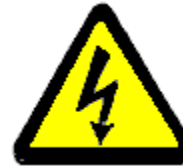
Tensione elettrica pericolosa
